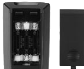
Figure 17 – Compartiment à piles de la télécommande
